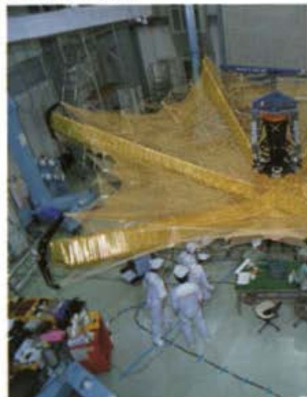
電波望遠鏡衛星「はるか」に搭載する8メートルパラボラアンテナの地上展開試験。
