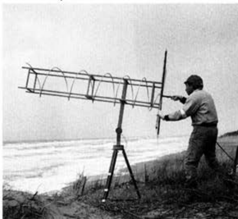
写真上・手作りの追跡用アンテナ。もちろん手動で追尾する。写真下・カッパB型ロケットの前の二人のリーダー。左が糸川英夫東大教授。右は観測責任者の前田憲一京大教授
