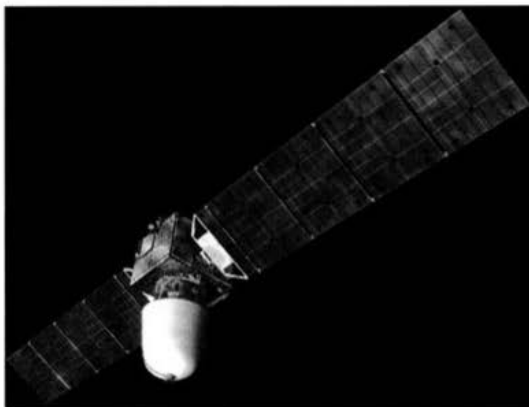
軌道上のUSERS（想像図）下部の白い部分が再突入カプセルとして切り離されて地球に帰ってきた。
